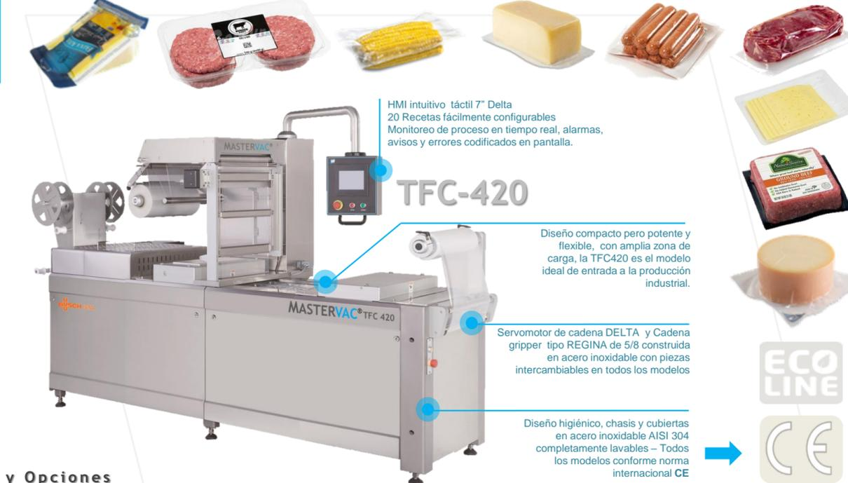
HMI intuitivo táctil 7" Delta 20 Recetas fácilmente configurables Monitoreo de proceso en tiempo real, alarmas, avisos y errores codificados en pantalla.
